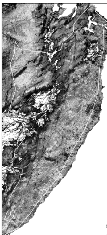
Рис. 3.5.3. ЦМР Сихотэ-Алинской складчатой системы, обработанная расчетом модуля градиента рельефа
