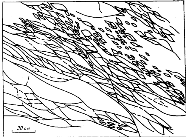
Рис. 4. Распределение поверхностей срывов в песчано-алевролитовой пачке, образующих многопорядковую линзовидную структуру тектонических микститов.
