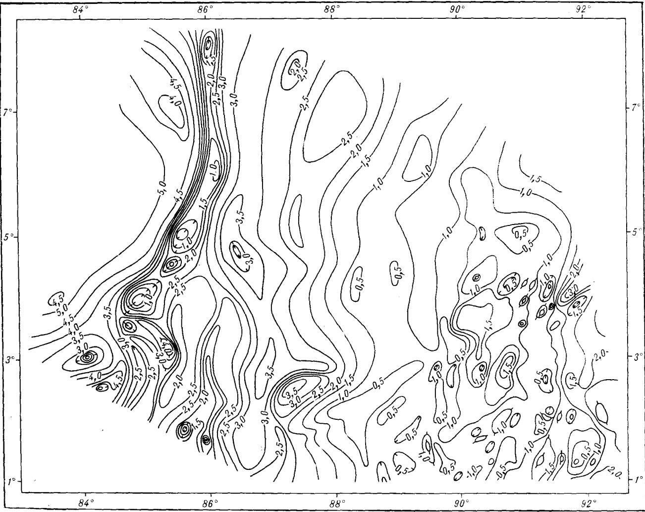
Рис. 3. Карта рельефа акустического фундамента (мощности осадков) юго-запада Бенгальского залива. Изолинии глубин даны от поверхности дна. Составлена на основе разрезов, полученных во время экспедиций, и литературных данных.
