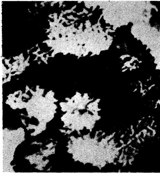
Рис. 3. Глобулы кристобалита, между которыми сохраняется полое поровое пространство,  $\times 1100$ .
