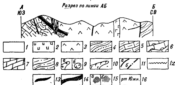
Рис. 1. Схема геологического строения полиметаллического рудопроявления Орлиное.
