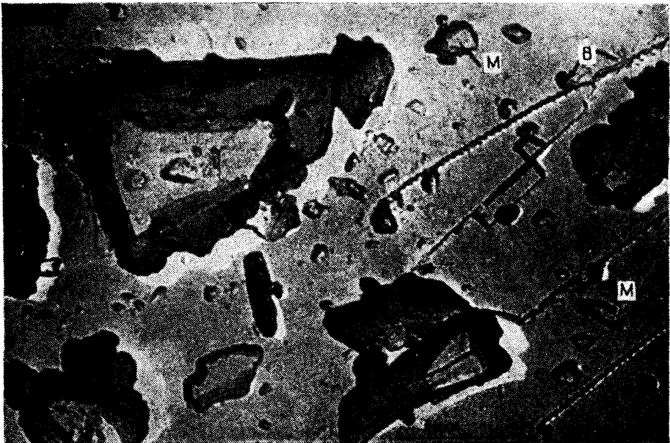
Рис. 2. Стекловатая часть породы образца Ш-80017. В — веретенообразные структуры; М — микролиты. Увеличение 12 000.
