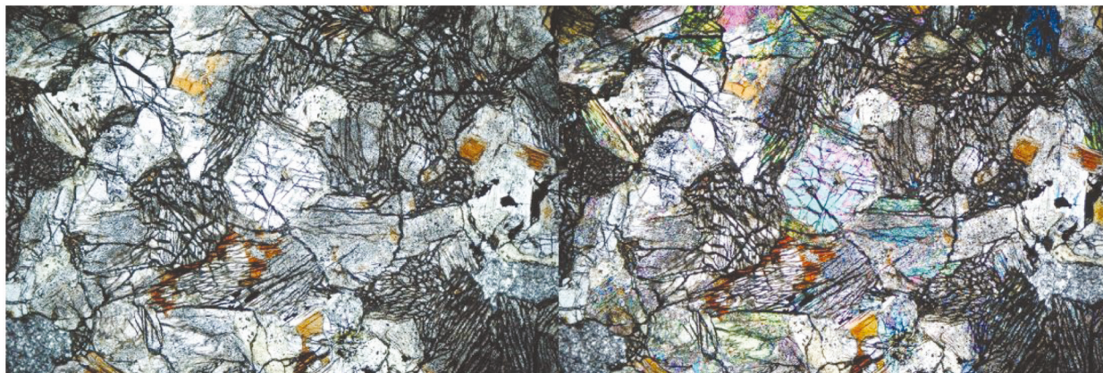
Рис. 4. Зерна оливина (светлое) с каймой серпентина в клинопироксените. Увел.10 диаметр 2.3 мм.
