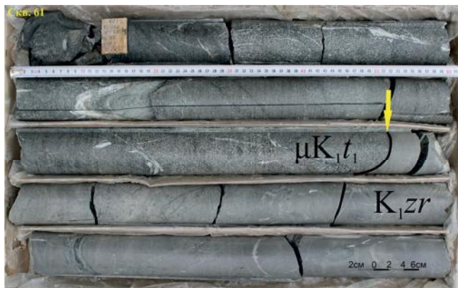
Рис. 3. Секущий контакт между монцогаббродиоритами ( \mu K_1 t_1 ) и ороговикованными алевролитами журавлевской свиты ( K_1 zr ). Скважина 61, интервал 122.9–126.0 м.
