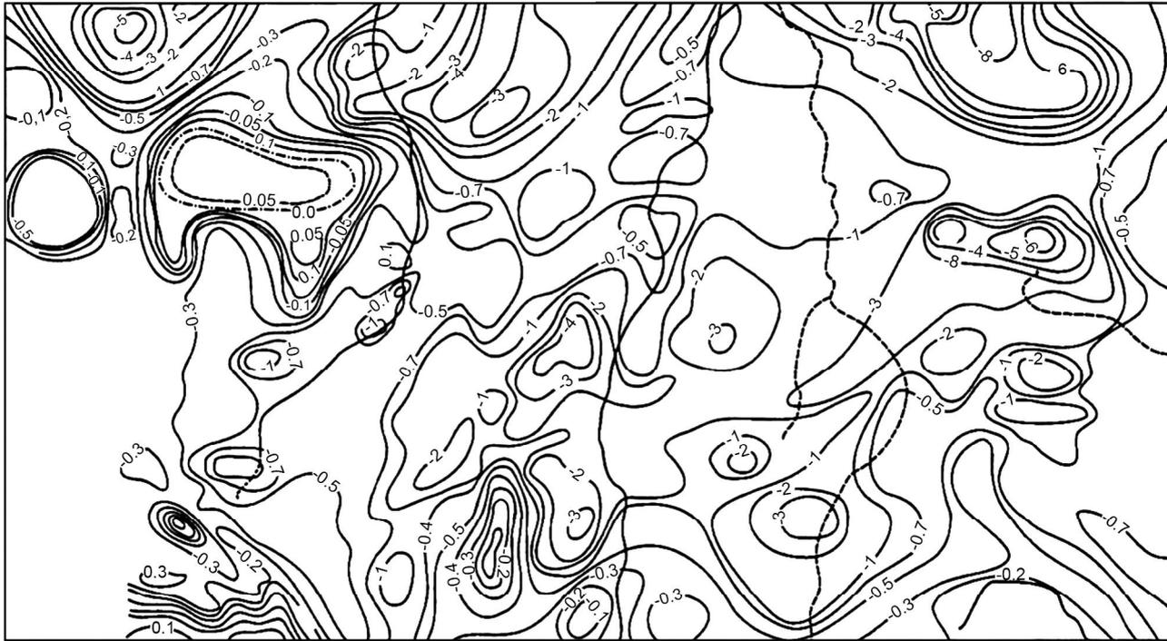
Рис 2. Карта-схема изолиний потенциала естественного электрического поля  $U_{EP}$  в В, участок Угдан.
