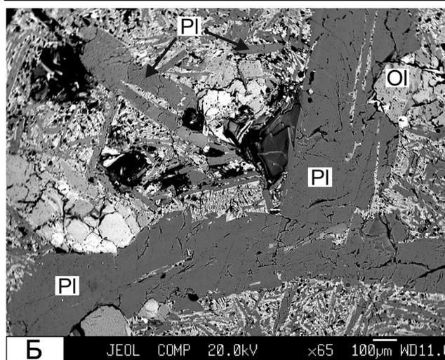
Рис. 6. Закалочная микроструктура базальта с крупными вкрапленниками оливина (Ol) (А) и плагиоклаза (Pl) (Б). Плагиоклаз в базальтах образует разновидность с закалочной структурой спинифекса, формируя игольчатые формы развития кристаллов.
