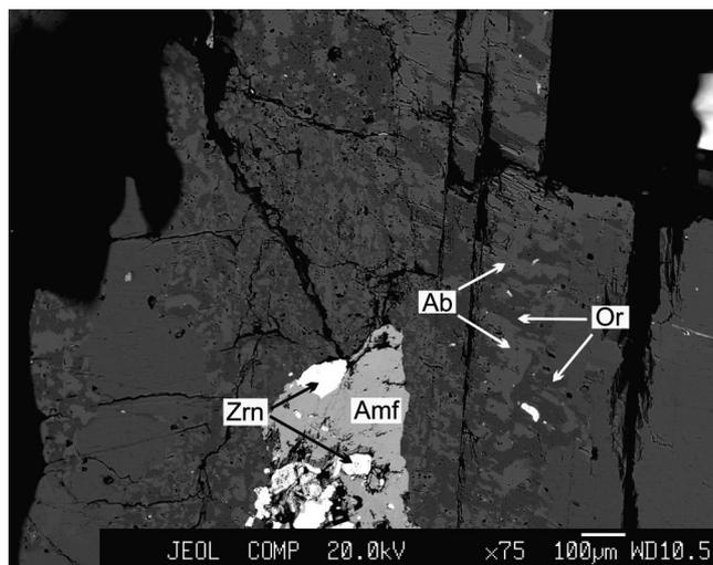
Рис. 5. Микропертитовые прорастания альбита (Ab) (светлое) и ортоклаза (Or) (темное) в сиените, а также крупные зерна циркона (Zrn) в амфиболе (Amf).
