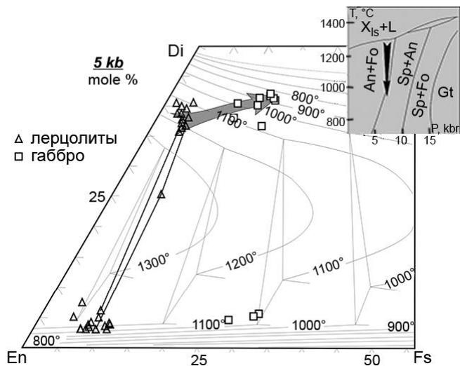
Рис. 10. Условия образования кристаллических пород трого Кайман по данным минералогических термобарометров Д. Линсли и Т. Гаспарика [26, 33].
