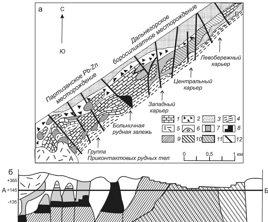
**Рис. 10.** Схема зональности и соотношения ранних и поздних скарновых ассоциаций на основе совмещенного генерализованного плана горизонта «+145 м» Дальнегорского боросиликатного и Партизанского Pb-Zn месторождений (а) и проекции рудных тел по линии А–Б в плоскости вертикального контакта тела триасовых известняков (б), по материалам ГХК «Бор» и ГМК «Дальполиметалл».
