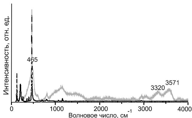
**Рис. 6.** КР-спектр стекла расплавного включения в кварце.
