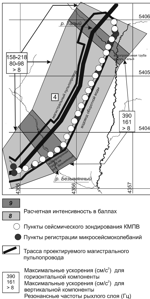
Рис. 7. Карта-схема проявления прогнозной сейсмичности для площадки магистрального пульпопровода.
