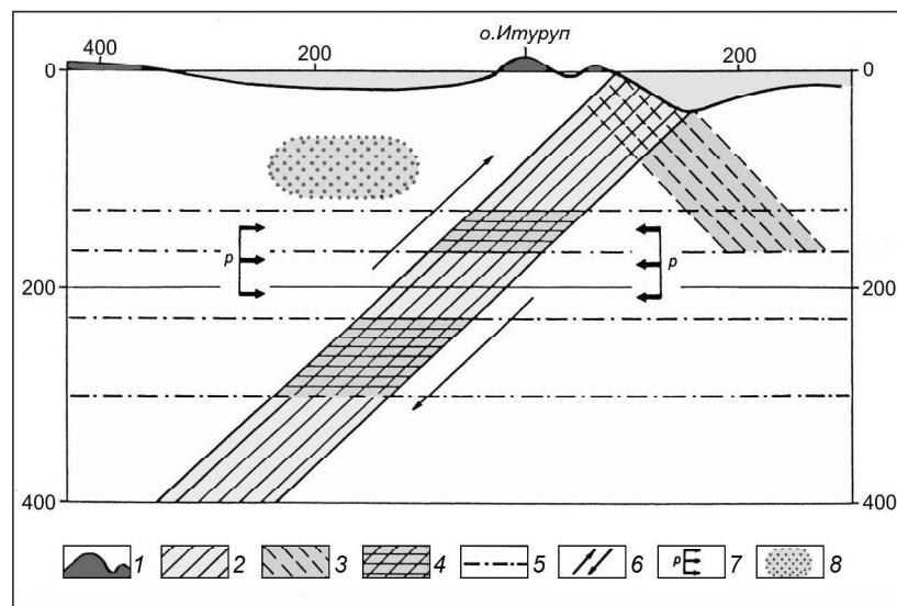
**Рис. 1.** Схема образования сейсмофокальной зоны как системы глубинных нарушений под влиянием постоянно действующих горизонтальных сил сжатия на границе континентальных и океанических структур [20, 32].
