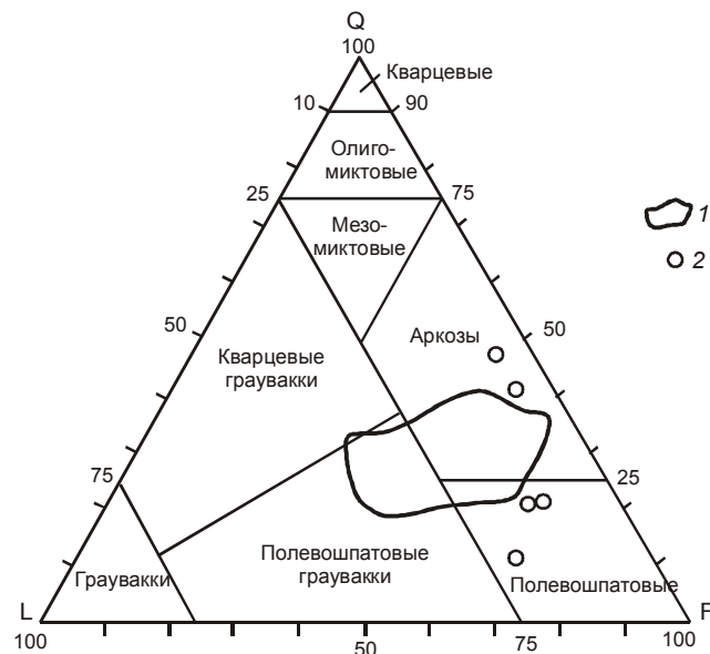
Рис. 2. Соотношение породообразующих компонентов титон-валанжинских песчаников бассейнов рек Пильда и Лимури Нижнего Приамурья на классификационной диаграмме В.Д. Шутова [13].
