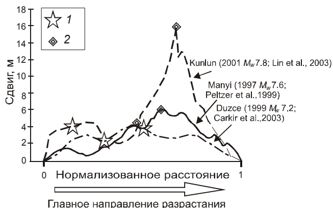
Рис. 1. Расположение главных очагов землетрясений и максимальных амплитуд горизонтальных смещений по простиранию активных разломов [25].
