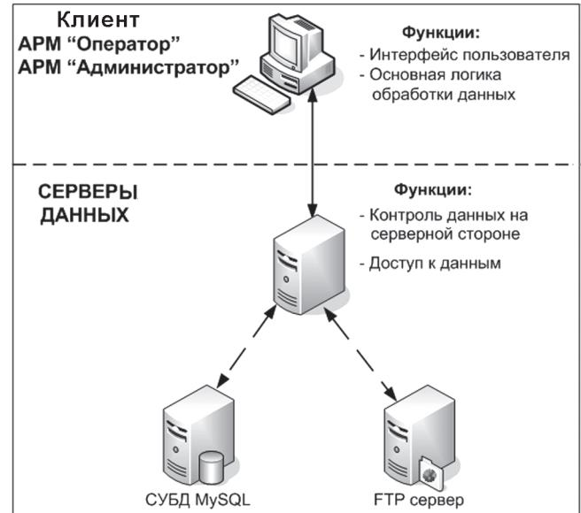
Рис. 4. Использование двухуровневой архитектуры “клиент-сервер” в системе.
