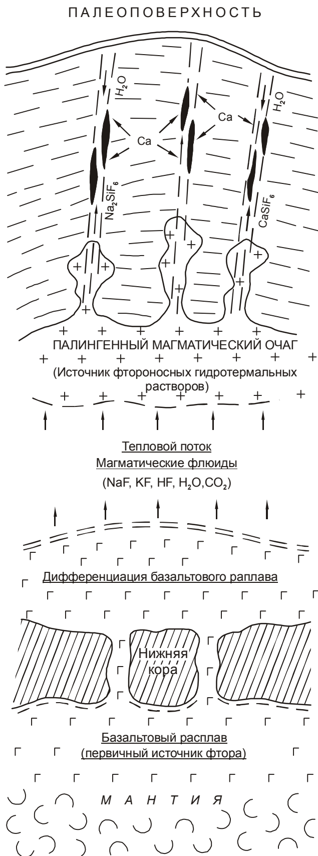
Рис. 2. Схема эволюции источника фтора эпитермальных флюоритовых месторождений.
