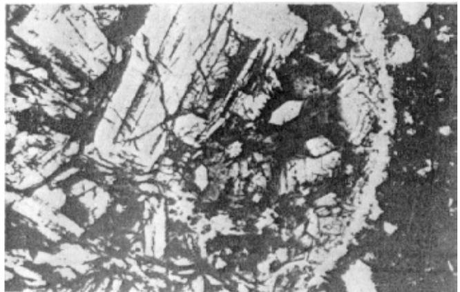
**Рис. 20.** Капля диаметром 0,8 мм ультраосновной породы, состоящей из ортопироксена и оливина в буром прозрачном стекле, из образца № 14 313, сборки "Аполлона-14".
