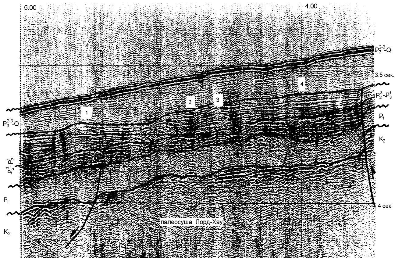
Рис. 9. Фрагмент профиля Г-20 через палеосушу Лорд-Хау с несогласиями, стратиграфическими перерывами (волнистые линии) и аномалиями типа “залежь”.
